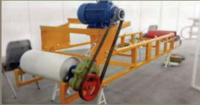
شاسی پروفیل متعلق به نوار نقاله ثابت
