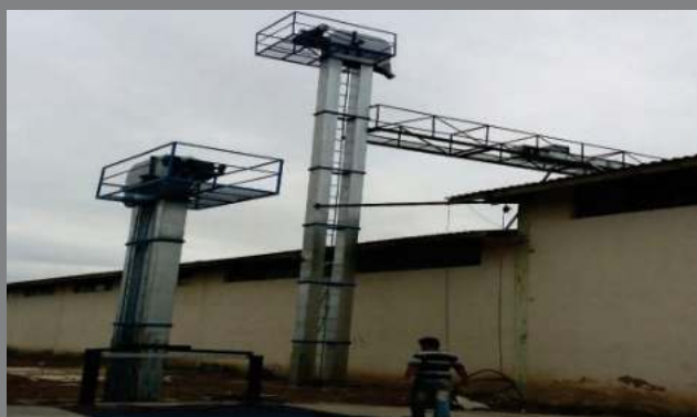
الواتور جهت انتقال عمودی مواد فله
