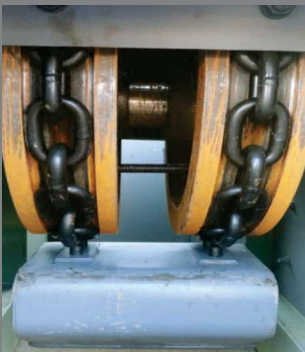
اتصال کاسه الواتور و زنجیر
